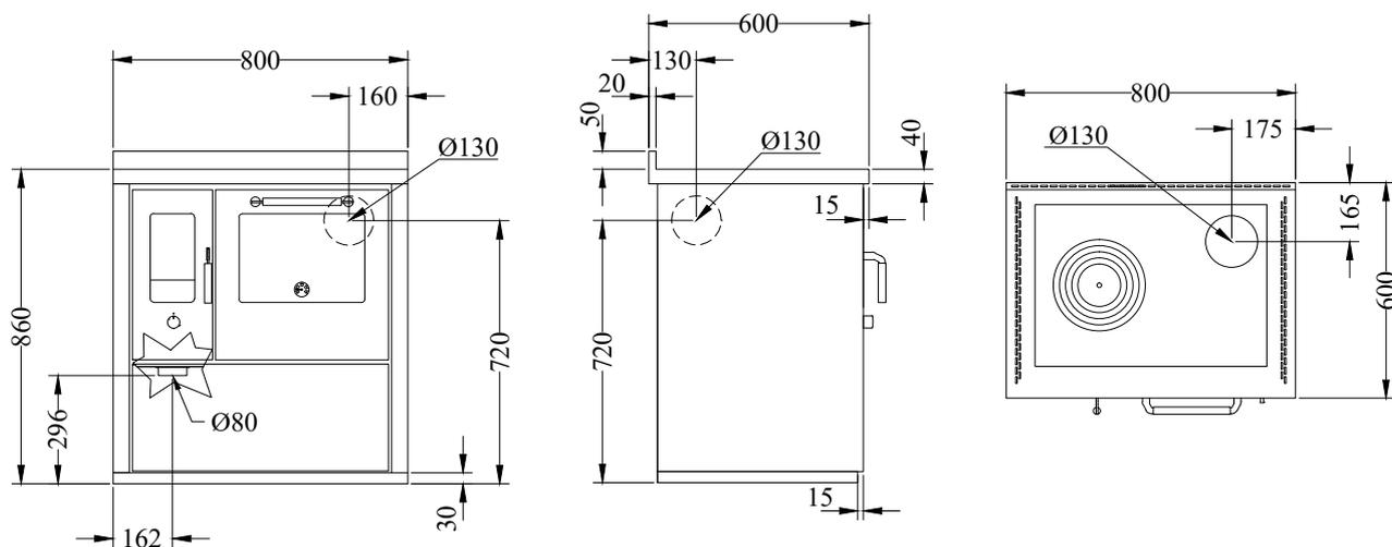
Version avec sortie de fumées à droite. La version avec sortie de fumées à gauche est symétrique.
